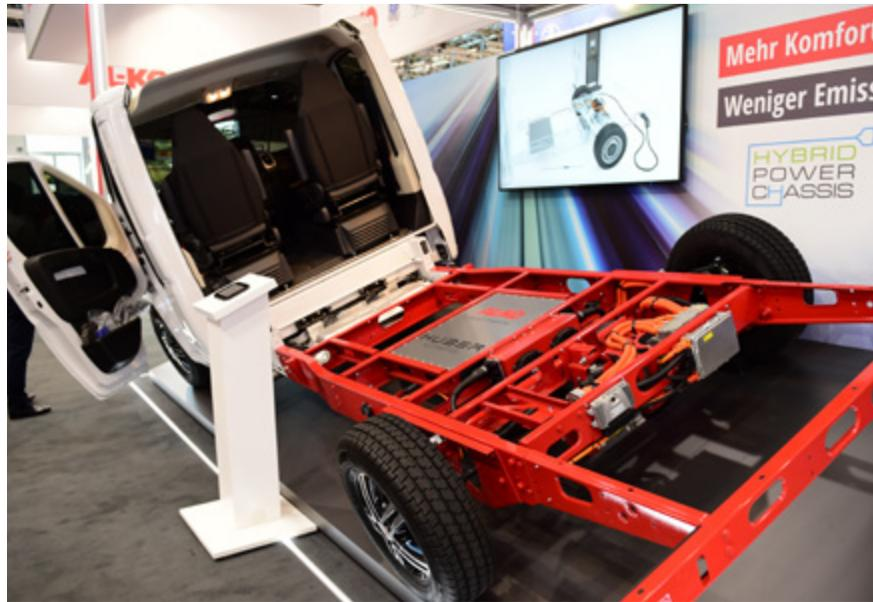
Elektrischer Allradantrieb und Umweltzonen lokal emissionsfrei befahren. Die Studie eines Hybrid Power Chassis von Alko Fahrzeugtechnik zeigt vorhandene Möglichkeiten auf
